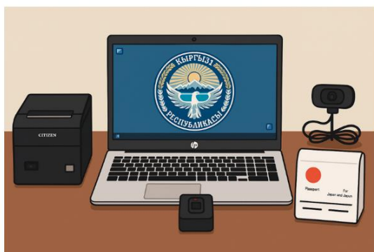
Оборудование идентификации состояло из 5 компонентов: ноутбук, ID-box, сканер отпечатка пальцев, веб-камера и термопринтер
